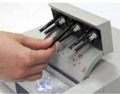
В целях безопасности анализа для хранения и установки электродов в анализатор используются специальные электродные колпачки, предотвращающие непосредственный контакт химика-аналитика с поверхностью электрода.
