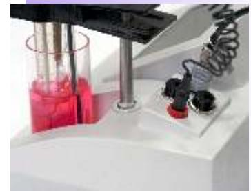
Удобное расположение разъемов для подключения электродов и датчиков к прибору делает возможным оперативно конфигурировать измерительную ячейку.
