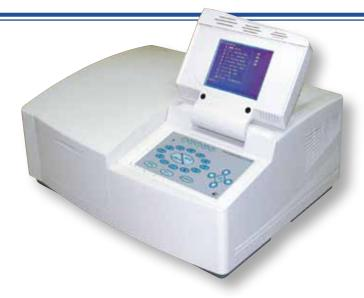
Специальные режимы работы (режим «ДНК/Белок»). Режим «ДНК/Белок» позволяет измерять концентрацию ДНК (РНК) в присутствии белков и измерять концентрацию белков в присутствии ДНК (РНК). В системе заложено два нередактируемых стандартных метода и один настраиваемый пользователем метод.
