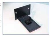
Поворотный держатель для твердых образцов. Поворотный держатель для твердых образцов используется для установки твердых образцов под углом к падающему лучу. Настройка угла падения луча возможна в интервале от -45° до +45°. Максимальные размеры образца 80x55x5мм. Доступен для
