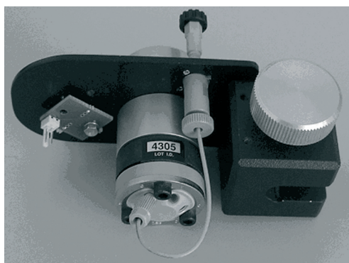
Модель 9740 в сборе с игловым портом 9012
